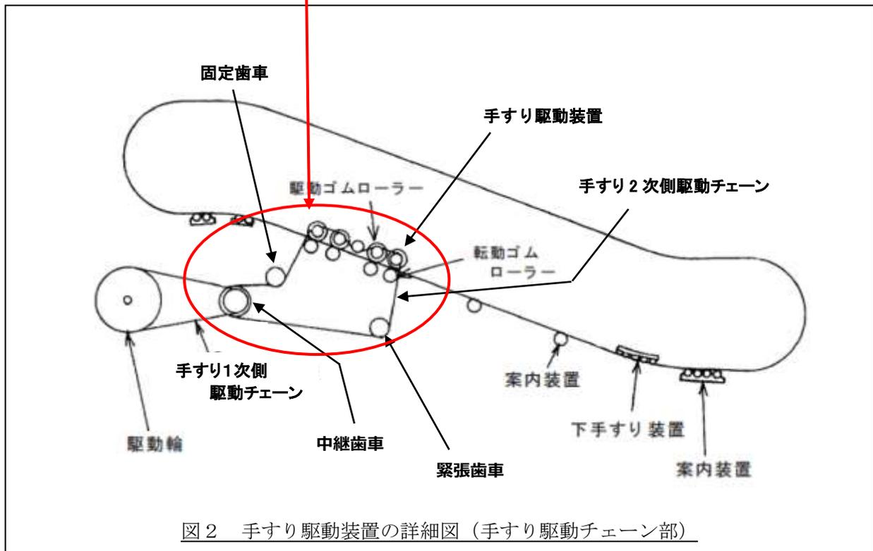
図2 手すり駆動装置の詳細図（手すり駆動チェーン部）
