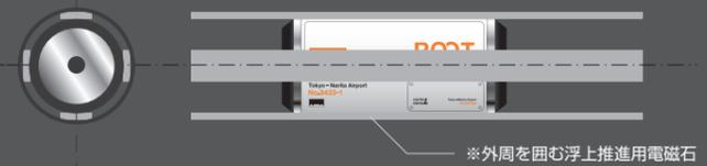
貨物輸送シャトル ROOT は、真空のチューブの中をシャトルが超高速で移動する輸送システムである。チューブ内を真空にし、摩擦力と空気抵抗をゼロに近づけることにより、最小限のエネルギー付加で輸送する。チューブ内のシャトルはリニアモーターカーとして移動する。速度はマッハ5~6で、チューブは地下100mに建設し、加速には重力も利用するため、横浜-成田間を約1分で走行する。またこのシャトルはあくまで貨物輸送のみの使用のため、無人である。そのため、シャトル内の酸素の確保等は不要になる。
