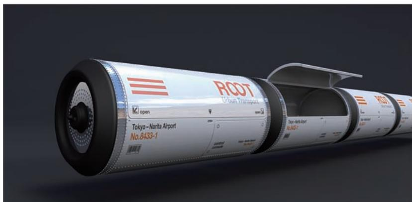
シャトルは側面のハッチが開き、荷物が積載できる。
