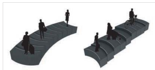
カーブの際に発生するステップの隙間は、ゴム状補助ステップによりフラットに埋められる。
