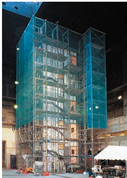
図3 実物大モデルを用いた5層階段室火災実験（提供：消防研究センター） 2001年に起きた新宿歌舞伎町雑居ビル火災を実物大モデルで再現した。5分30秒経過時点で5階まで火の海になっている。
