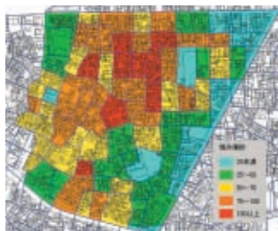
図2 延焼危険度マップ(提供:財団法人国土技術研究センター) 市街地火災延焼シミュレーションモデルを組み込んだ防災まちづくり支援システムでは、実際の市街地の延焼危険度を評価できる。同システムには防災アクティビティシミュレーションモデルも組み込まれており、避難、消防活動、救出活動に関する危険度も評価できる。
