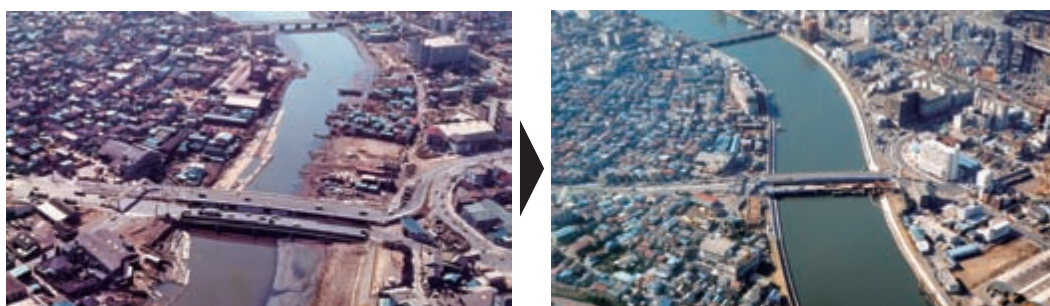
図3 河川の拡幅による総合治水対策の例
