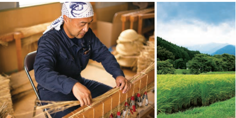
(左) 手製の治具。藁を継ぎ足しクリップの錘で締める。 (右) 飯島町の田園風景。山に囲まれ、強風には守られる地形だ。
