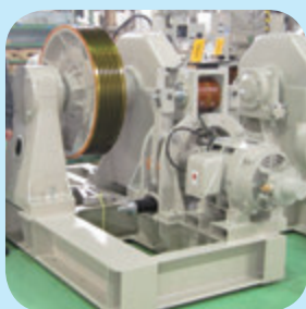
検査・塗装が済まされ、万全の状態で据付現場への出荷を待つ巻上機。
