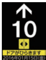
液晶インジケーター 色覚の個人差を考慮した色が採用されている
