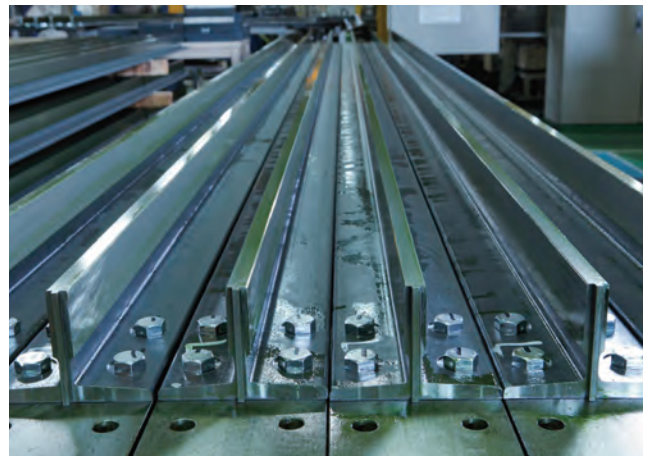
東京スカイツリーに使用されたガイドレール。これらを1本1本高精度につなげていった。
