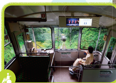
車内へは階段昇降機で。最大約30度の斜面を登るケーブルカーは、2両編成260人乗り。
