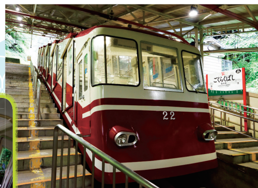
車内へは階段昇降機で。最大約30度の斜面を登るケーブルカーは、2両編成260人乗り。
