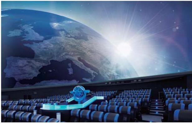
「天空」の内部。中央には、リアルな星空を映し出す光学式と、宇宙空間を迫力の映像で再現するデジタル式の2種の投射機が設置されている。
