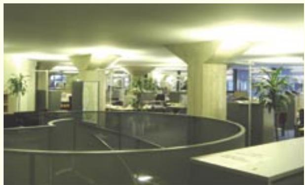
▲サイロのある農業倉庫をオフィスにリノベーションしたフィンランドの事例。照明を間接照明とすることで階高の低さを補っている。
