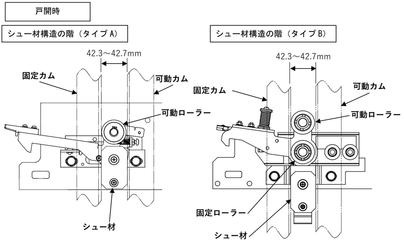
※シュー材構造でない階の戸開時の寸法は、全階床のインターロックがシュー材構造でない場合と同じ。
