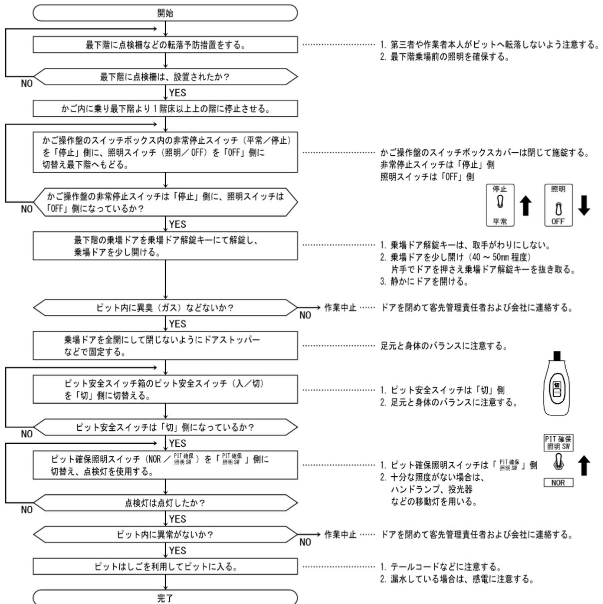
注記：ドアゾーンをはずれた範囲で戸開すると、戸開走行保護装置が動作してエレベーターの運転が不能になります。
