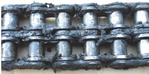
チェーン表面を覆うへドロ状の付着物がある場合は、潤滑油が行き渡っていない状態のため付着物を除去する
