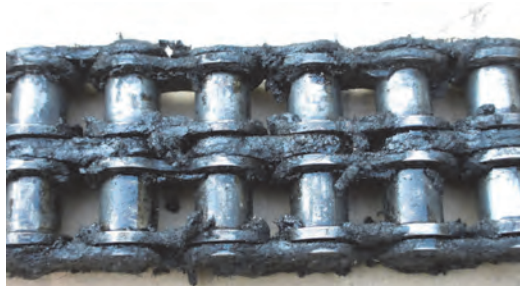
チェーン表面を覆うへドロ状の付着物がある場合は、潤滑油が行き渡っていない状態のため付着物を除去する
