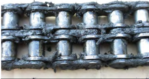
チェーン表面を覆うヘドロ状の付着物がある場合は、潤滑油が行き渡っていない状態のため付着物を除去する
