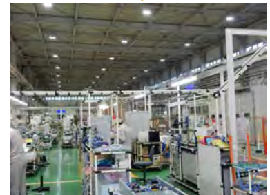
製造工程室内照明のLED化による消費電力削減
