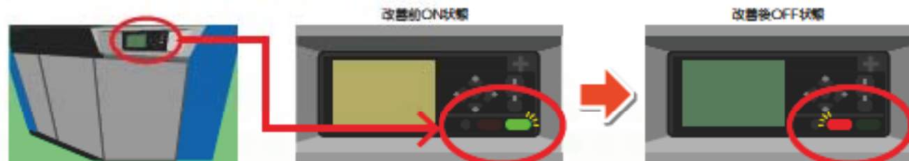
コンプレッサー稼働時間の制御(ON/OFF状態)による電力使用量の削減(1.44万kWh/年)
