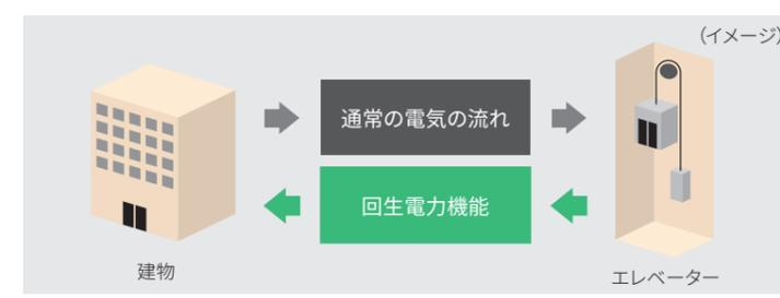
回生電力機能で回生運転の際に発生した電力を建物に戻し、電力を有効利用できます。
