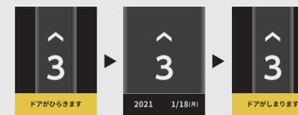
ドア開閉時に大形液晶インジケータに表示され、ドア開閉に合わせてアニメーションでお知らせします。
