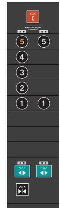
「行先階ボタン」と「ドア開ボタン」の上部にそれぞれ「背面」「正面」のプレートを設置します。
