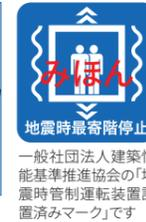
一般社団法人建築性能基準推進協会の「地震時管制運転装置設置済みマーク」です
