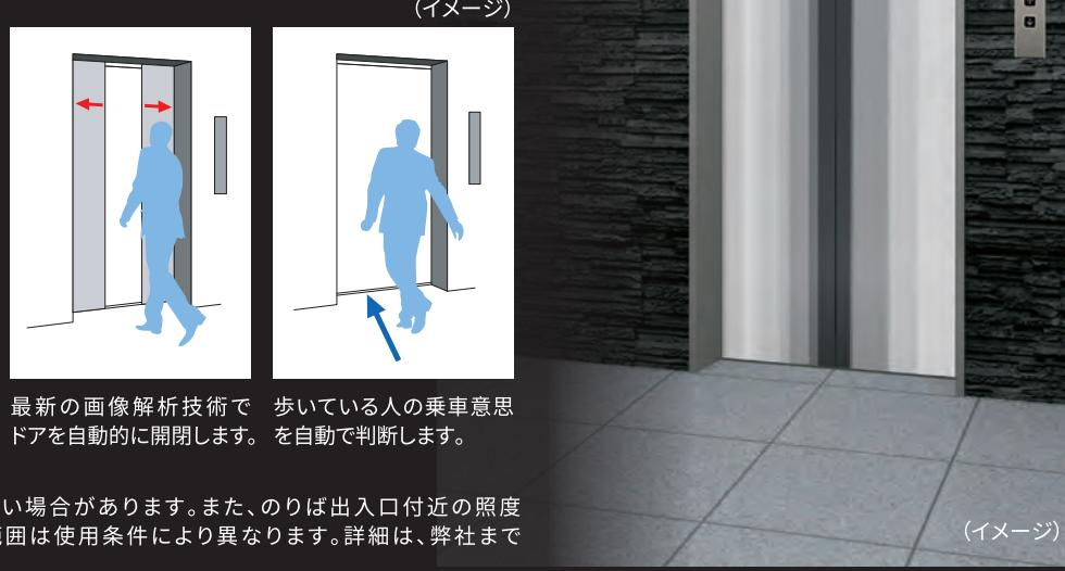
最新の画像解析技術で歩いている人の乗車意思ドアを自動的に開閉します。自動で判断します。
