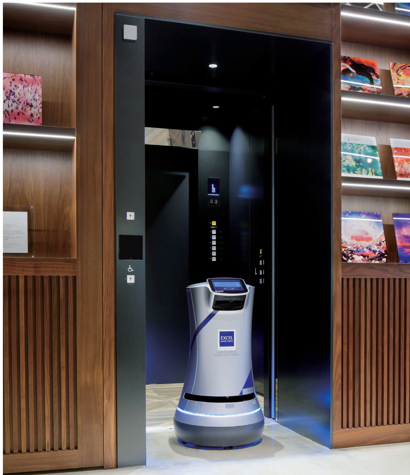
乗用15人乗りエレベーターとデリバリーサービスロボット「Relay（リレイ）」・4階エレベーターのりば
